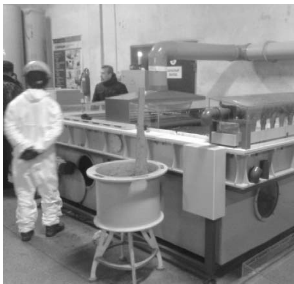
Електрохімічний реактор анодного окислення графіту для одержання ТРГ
