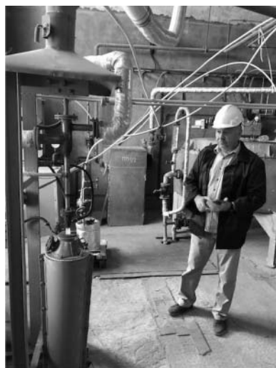
Промислова установка пірогенного синтезу змішаних оксидів металів-каталізаторів одержання вуглецевих нанотрубок
