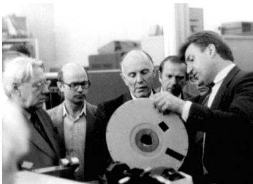
Оптичний накопичувач інформації ЄС 5150 та оптичний диск ЄС 5153 ємністю 2,5 Гбайт
