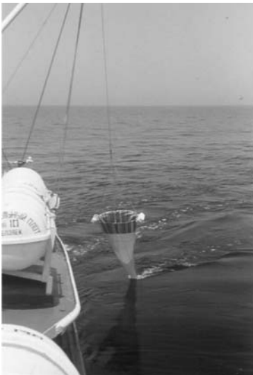
а б Знаряддя збору нейстону: а — мальково-нейстонний трал (МНТ), б — двоярусна планктонна-нейстонна сітка (ПНС-2)
