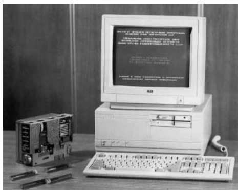
Накопичувач інформації ЄС 5350 на оптичних циліндрах
