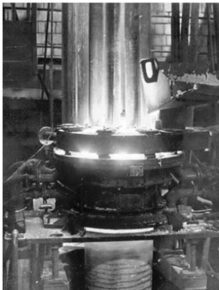
Установка УШ-126 для електрошлакової виливки порожнистих злитків (а) та литий електрошлаковий злиток масою 13 т (б). Завод «Дніпроспецсталь», Запоріжжя
