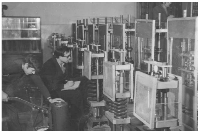
Стенди для випробувань і моделювання поведінки порід за межею міцності в лабораторії досліджень реологічних властивостей гірських порід Інституту
