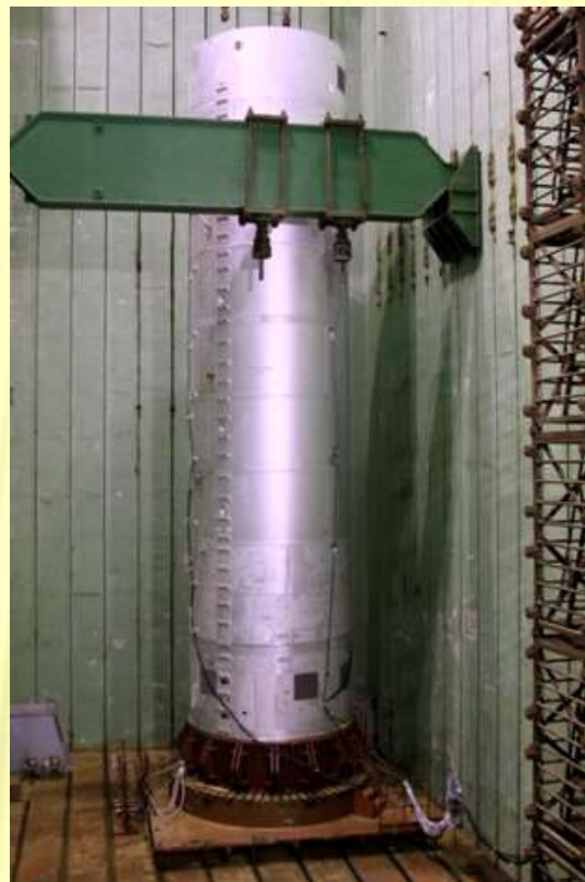
Установка для натурних випробувань баку
