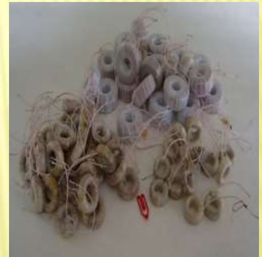
Мініатюрні трансформатори для високочастотних телекомунікаційних систем управління спеціального призначення
