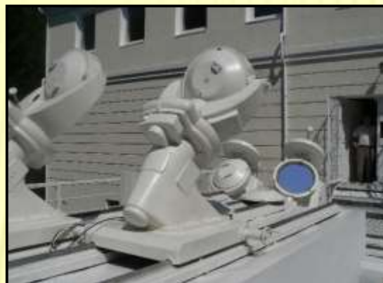
Целостатна установка телескопа Ернеста Гуртовенка з двома плоскими дзеркалами діаметром 44 см
