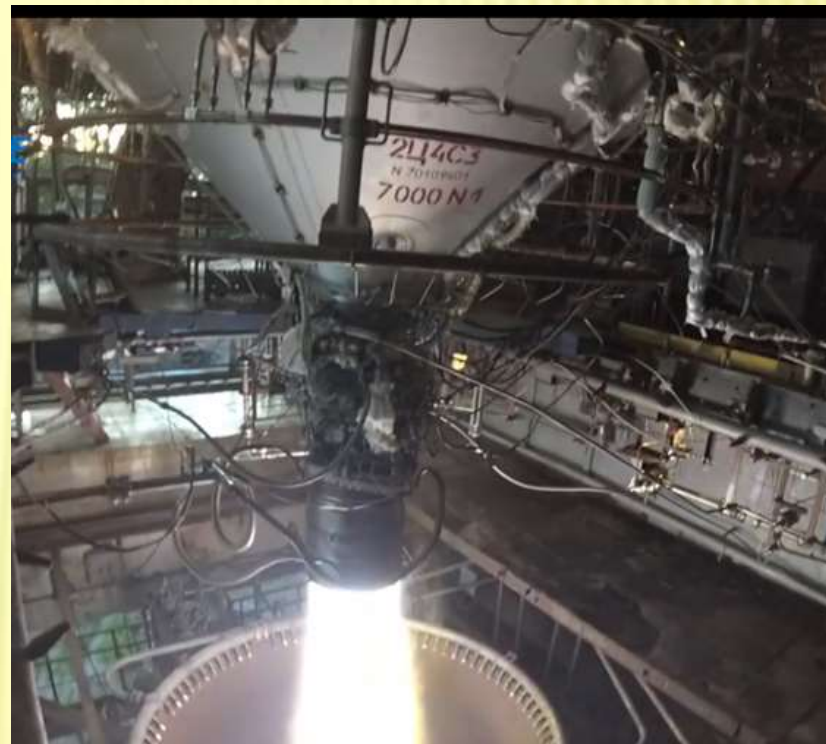
Вогневі випробування маршового двигуна верхнього ступеня ракети-носія разом з керуючими двигунами малої тяги
