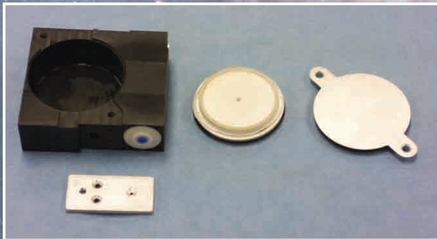
Розібраний тримач для чашки Петрі Non-assembled rack to hold a Petri dishe
