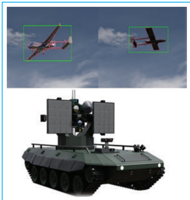
Мобільна роботизована платформа для виявлення та супроводження цілей на основі мультисенсорної системи, розробленої фахівцями Міжнародного науково-навчального центру інформаційних технологій і систем НАН України та МОН України
