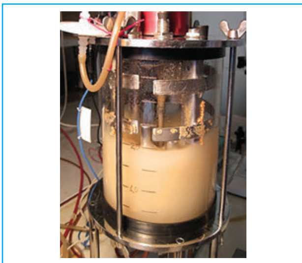
Напрацювання біомаси клітин актинобактерій, що входять до складу біопрепарату "Еколан-М", за їх спільного культивування у лабораторному ферментері марки Biotec
