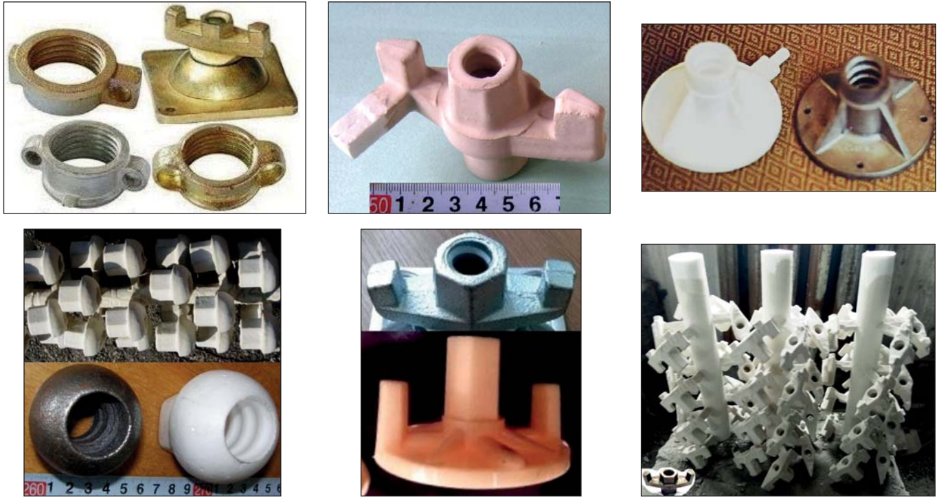
Рис. 4. Приклади металевих кріплень з литою різьбою, їх моделей з ППС (білого кольору) та модельних кластерів (кушів) для формування їх у ливарному контейнері
