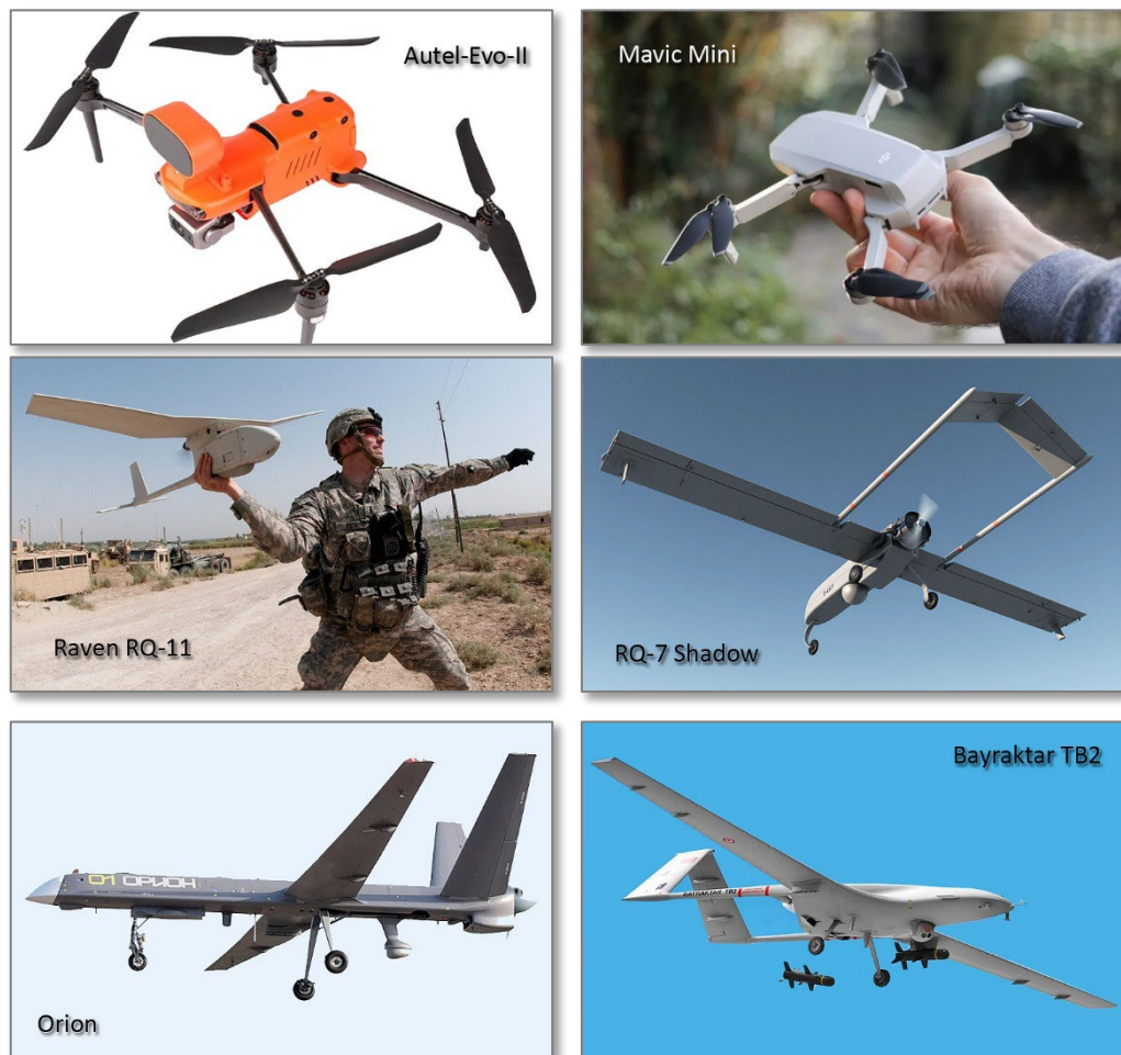
Рис. 1 – Зображення БПЛА до – Табл. 1: дуже малі: Autel EvoII; DJI Mavic mini; малі БПЛА: RQ-11 Raven; RQ-7 Shadow; великі: Orion; Bayraktar TB2
