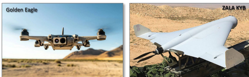
Рис. 17 – Golden Eagle – навігація без GPS/GLONASS, «КУБ» – безпілотник може баражувати у повітрі, виявляючи ціль, а потім атакувати її з верхньої півсфери вертикальним пікіруванням
