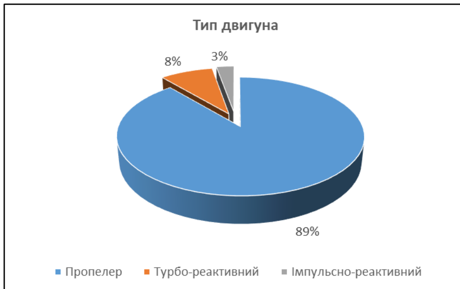
Рис. 26 – Співвідношення безпілотних летальних апаратів за видом рушійного зусилля
