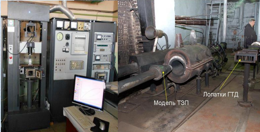
Стени для випробувань матеріалів та елементів конструкцій за умови імпульсного (ударного – до 1000 м/с) навантаження
