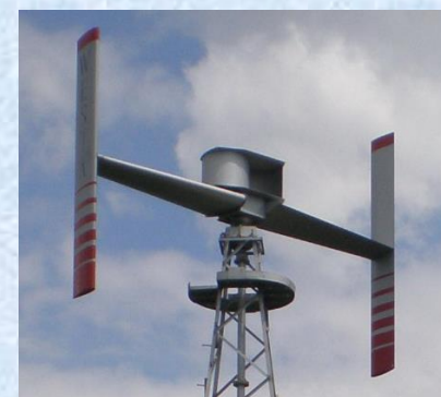
Аеродинаміка вертикально-осьової вітроенергетичної установки з роторами Дар'є та Савоніуса
