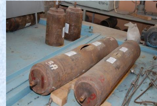
Пневмогідрравлічний кріогенний стенд (P до 100 МПа, T до -196 °C) та установки ( T до -269 °C )
