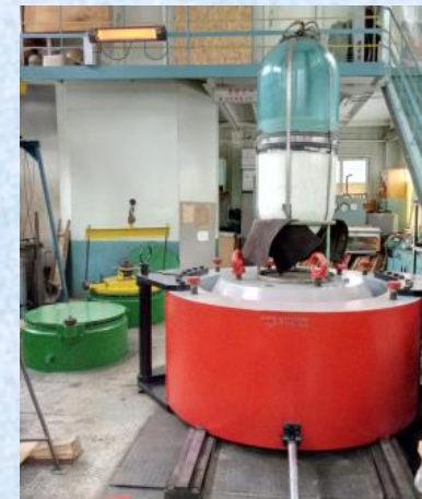
Пневмогідрравлічний кріогенний стенд (P до 100 МПа, T до -196 °C) та установки ( T до -269 °C )
