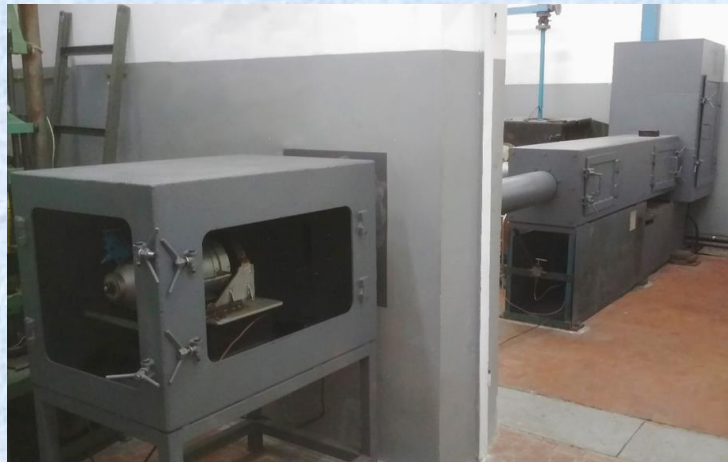
Стени для випробувань матеріалів та елементів конструкцій за умови імпульсного (ударного – до 1000 м/с) навантаження
