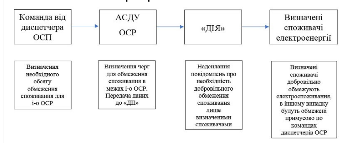
Рис. 1. Схема реалізації механізму добровільного обмеження споживання електроенергії.
