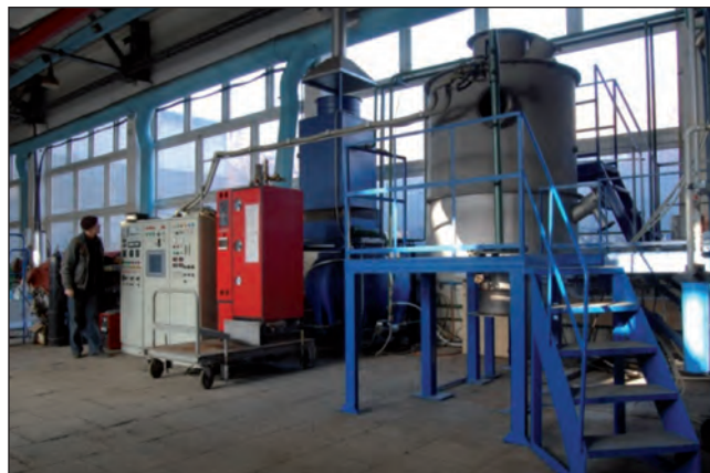
Обладнання для плазмово-парової переробки відходів продуктивністю 500 кг/год (розробка Інституту газу НАН України)
