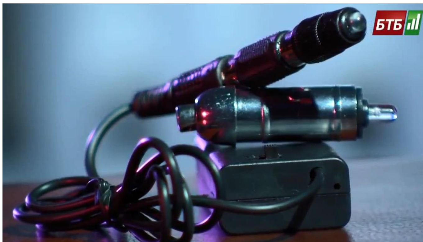
Зовнішній вигляд портативного офтальмоскопа «ІРІС» (фото – з відеосюжету телеканалу БТБ)
