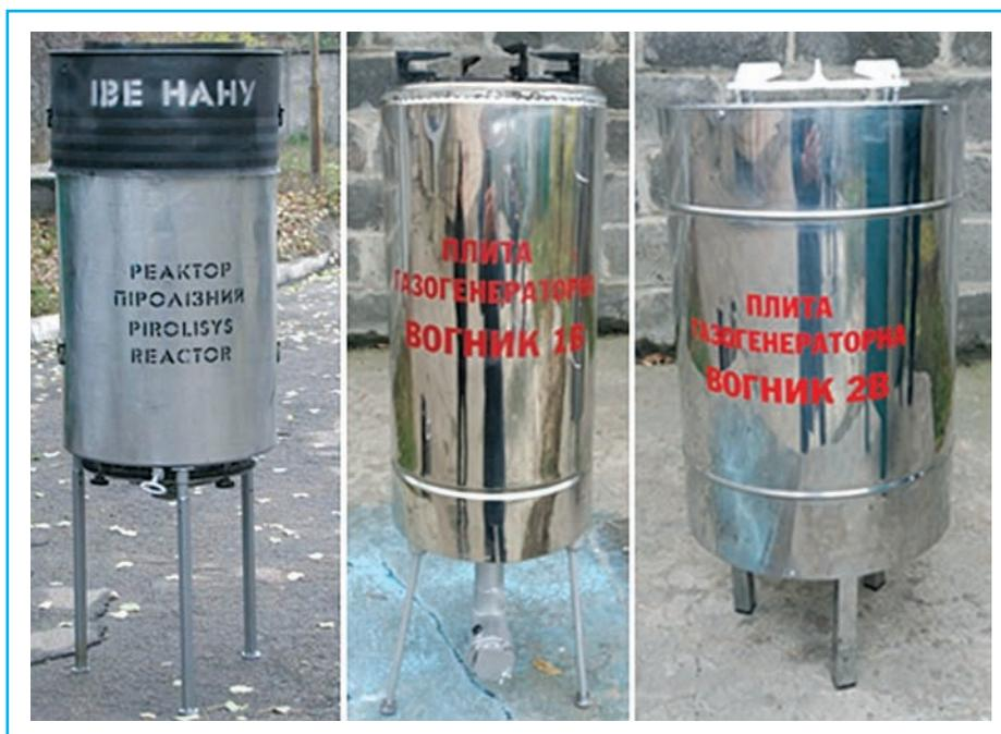
Фермерська установка періодичної дії для виробництва біовугілля та газогенераторні плити "Вогник 1В" та "Вогник 2В"
